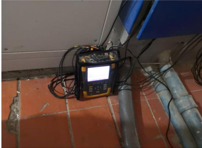
La metodología para la medición de las variables de calidad de la potencia, consistió en dejar instalado los equipos por 8 días aproximadamente con el fin de obtener la mayor cantidad de registros posibles para posteriormente ser analizados con el software PowerLock. A continuación, se describen las conclusiones de la muestra:
